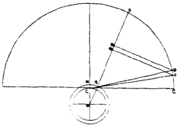
相合則有定處自地心過所合處作線抵圓周卽爲蒙氣割綫視綫與割綫成一角光綫與割綫亦成一角二角相減得蒙氣差角爰在北極出地高四十四度處屢加精測得地平上最大差爲三十二分一十九秒蒙氣之厚爲地半徑千萬分之六千零九十五視綫角與光綫角正弦之比例常如一千萬與一千萬零二千八百四十一用是推得逐度蒙氣差本法用之如圖甲爲地心乙爲地面丙乙爲蒙氣之厚丑甲爲割線癸乙爲視線子
