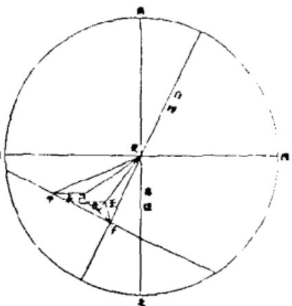
即爲定真時如圖乾爲日心乾子爲用時兩心實相距乾壬爲高下差壬子爲兩心視相距乾午爲設時兩心實相距乾己爲高下差己午同壬未爲兩心視相距壬丑中垂綫爲真時視相距初虧復圓法同但以併徑爲比考真時之限至帶食則以地平爲斷亦逕求兩心視相距不用視行
